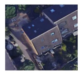
Dieses Reihenendhaus bekam 2018 ein Hauskraftwerk S10E E3/DC mit 10kwh Batteriekapazität. Die südliche Dachfläche bietet 15 Modulen Platz, mit damals je 305w ergeben sind 4,6kwp Leistung und ca. 4.500kwh Ertrag per anno.
