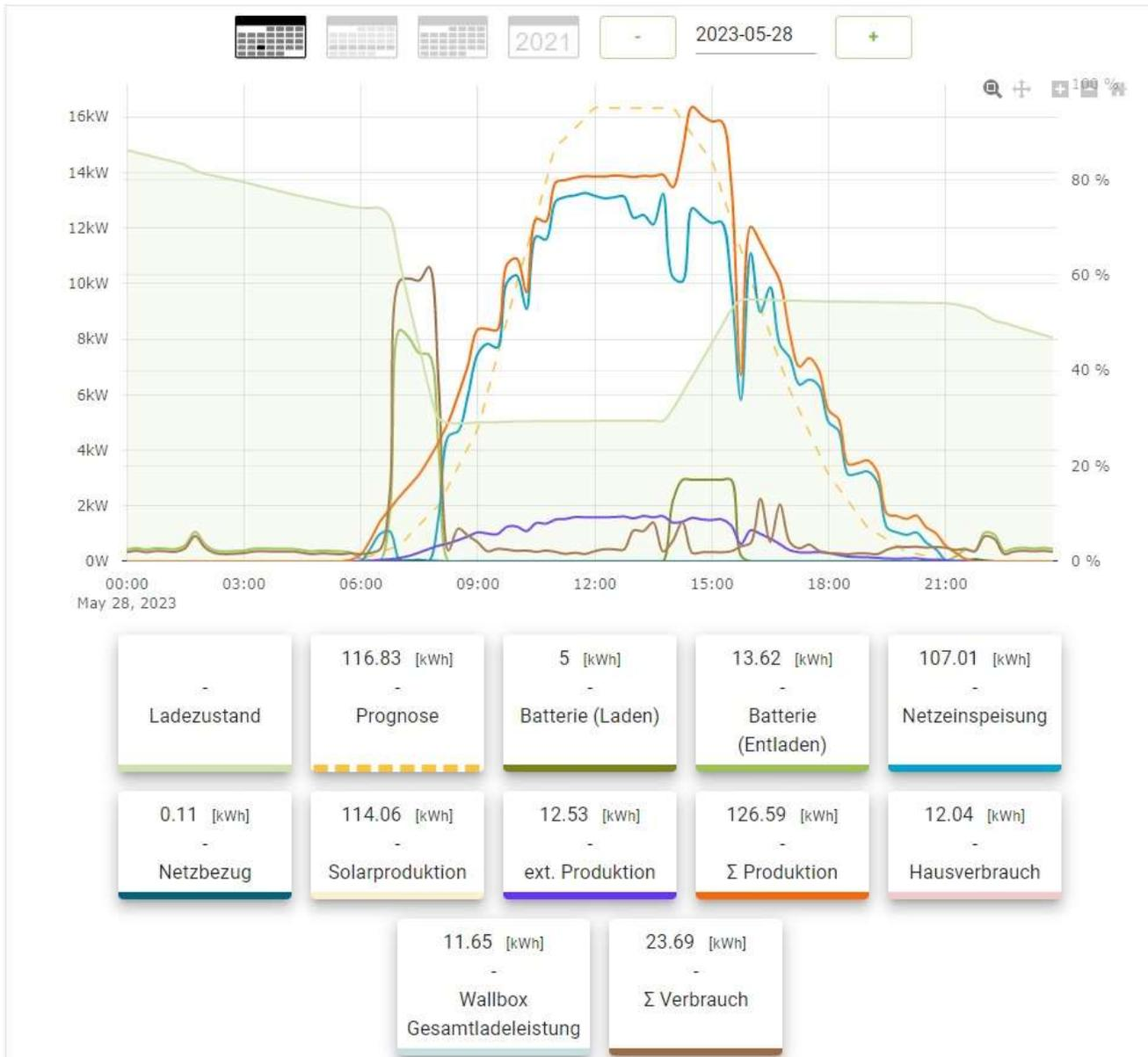
obwohl tags zuvor nur auf knapp 60% geladen versorgt die Batterie locker auch über die Nacht. Um 6:00 startet wieder die Solare Erzeugung.
