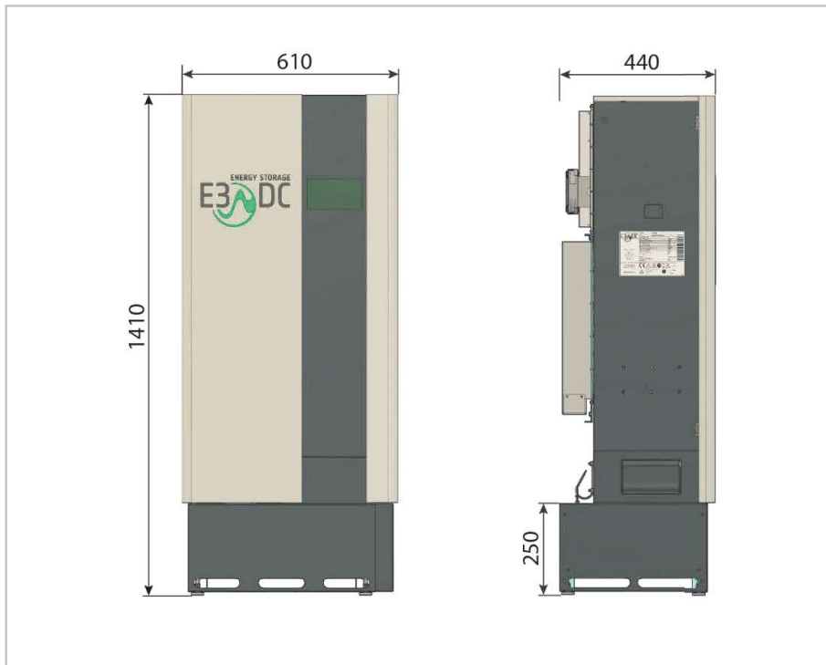
Abb. 5: Abmessungen elektrische Funktionseinheit (in mm)
