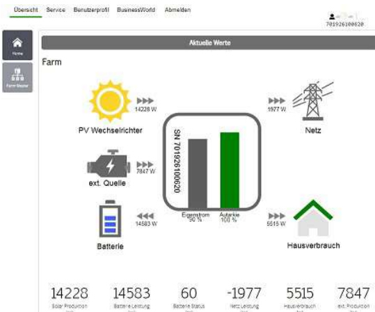
37kwp auf Bürogebäude mit 65kwh Batteriekapazität LG mit Tigo Optimierern Alfotec GmbH – 42929 Wermelskirchen
